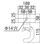
※上端を床から60cm以上突出させて取付けてください。
